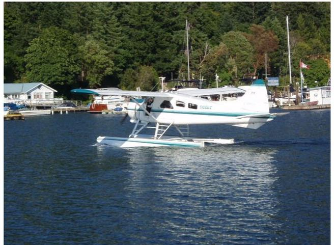
水上飛行機（下駄履き飛行機）マリーナの桟橋にボートのように簡単にムアリングしてしまう。
